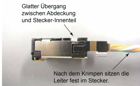
Prüfung der Krimpverbindung
